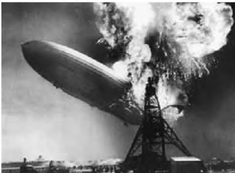
▲ Figura 5.14 El incendio del dirigible Hindenburg lleno de hidrógeno. Esta fotografía fue tomada sólo 22 segundos después de que ocurrió la primera explosión. Esta tragedia, la cual ocurrió en Lakehurst, New Jersey, el 6 de mayo de 1937, hizo que se dejara de utilizar al hidrógeno como gas de flotación en tales naves. Los dirigibles modernos se llenan de helio, el cual no flota tanto como el hidrógeno, pero no es inflamable.
